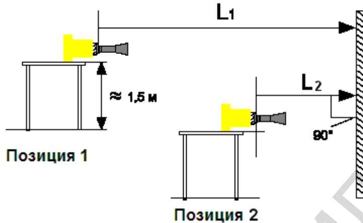
устанавливают в позицию 1 на расстояние  $L_1$ , проводят измерения и записывают в протокол измеренные значения расстояния  $L$  и  $L_y$  в позиции 1 по рулетке ( $L$ ) и с дисплея модуля индикации и настройки уровня ( $L_y$ ).
